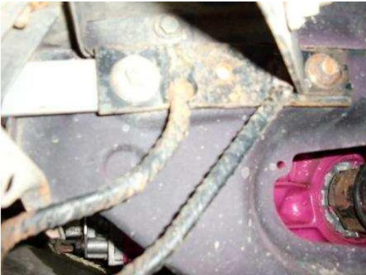
Anneau boulonné sur les points de fixation du par chocs au châssis
