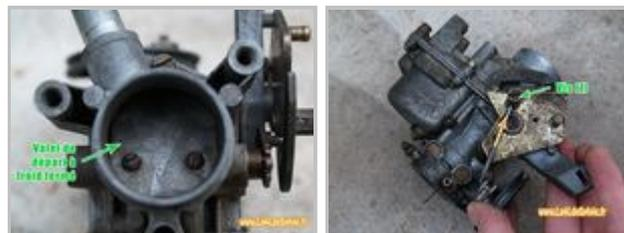
Et voilà, le carburateur est prêt à être remonté sur la pipe d'admission en n'oubliant pas évidemment la cale pare-chaueur et les 2 joints de part et d'autres de cette cale.
