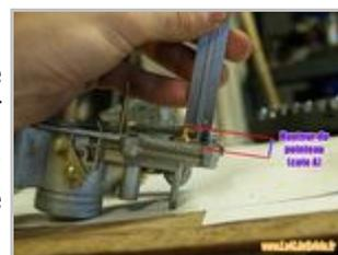
Remonter la cuve en mettant un joint neuf. Il s'agit juste un joint en "carton" qui ne demande pas de précaution particulière au moment de la pose.
