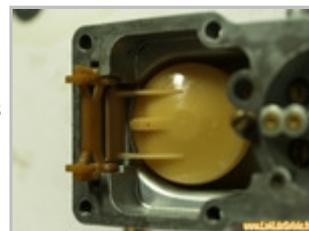
Démonter le gicleur principal pour le nettoyer => un simple tournevis suffit pour le retirer. Le but étant de vérifier que rien ne bouche les orifices du gicleur, un coup de soufflette ne faisant jamais de mal.
